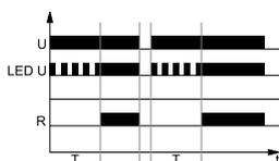
Включение напряжения питания U, начинает отсчет установленного времени T - задержка включения исполнительного реле R. После отсчета времени T, исполнительное реле R срабатывает и находится в позиции работы до момента отключения напряжения питания U.
