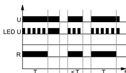
При включении напряжения питания U, сразу срабатывает исполнительное реле R и начинается отсчет установленного времени T. После отсчета времени T, исполнительное реле R возвращается в исходное состояние.
