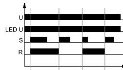
Напряжение питания U должно подаваться на реле времени непрерывно. При включении контакта управления S, сразу срабатывает исполнительное реле R. Каждое последующее включение контакта управления S, приводит к изменению состояния исполнительного реле R на противоположное (свойство бистабильного реле).
