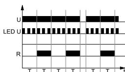
Включение напряжения питания U, инициирует циклическую работу с отсчета времени T - выключения исполнительного реле R, после которого наступает включение исполнительного реле R на время T. Циклическая работа длится до момента выключения питания U.
