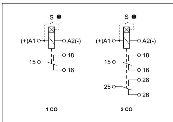
**Внимание:** указанная полярность питания, относится только к реле RPC-...-UNI. **!** Управляющий зажим S активизируется посредством подсоединения зажима A1, через внешний управляющий контакт S.
