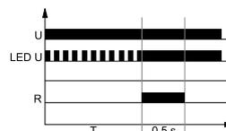
Включение напряжения питания U, начинает отсчет времени T, после чего исполнительное реле включается на период 0,5 сек. (время срабатывания замыкающего контакта исполнительного реле).
